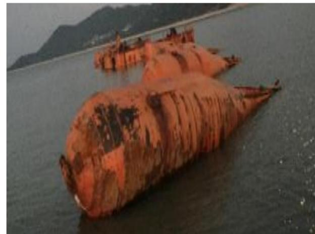
图 5.4 自适应浮筒锈迹斑斑
