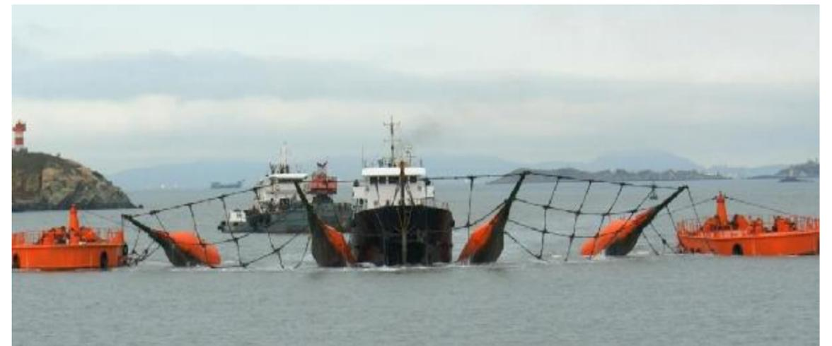
图4.1 拦截装置实船撞击实验
