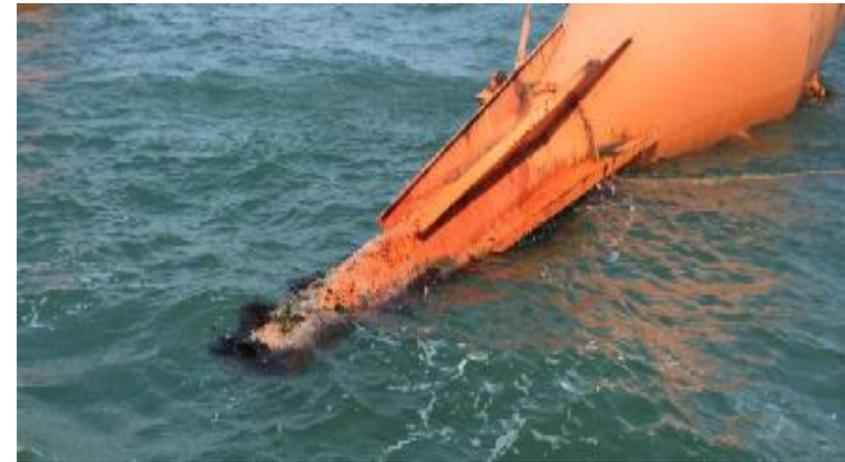
图 5.5 自适应浮筒尾部撞击断落
