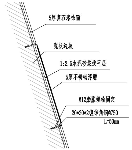
隧道入口端墙装饰剖面图
